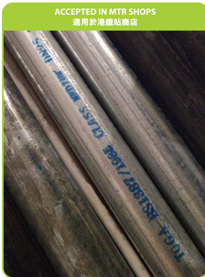
Galvanized steel tubes (BS 1387 "Medium" Grade) 英國標準1387（BS 1387）中級的鍍鋅鋼管
